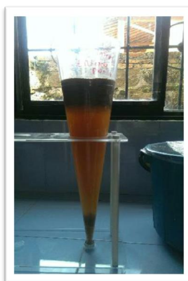
Agua residual separada, 8h
