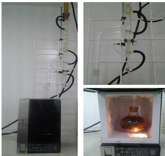
Figura 15. Montaje de hidrodestilación asistida por la radiación de microondas.
