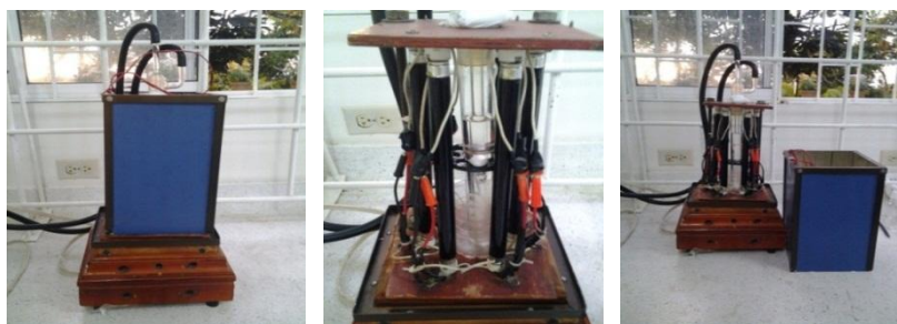
Figura 21. Reactor UV, equipado con un refrigerante y 6 lámparas fluorescentes F6T5BLB de 16 x 225.1 mm y 6 Watt.
