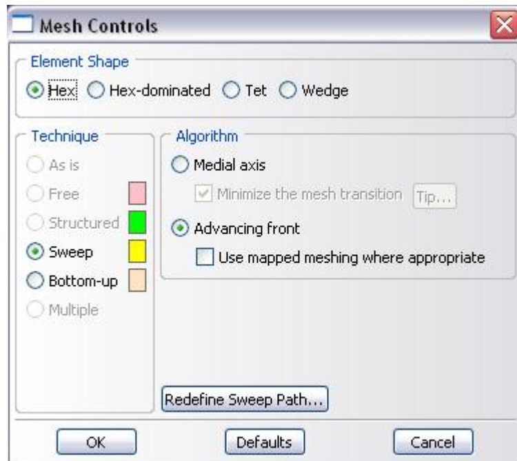
Figura B10. Caja de dialogo para asignar los controles de mallado
