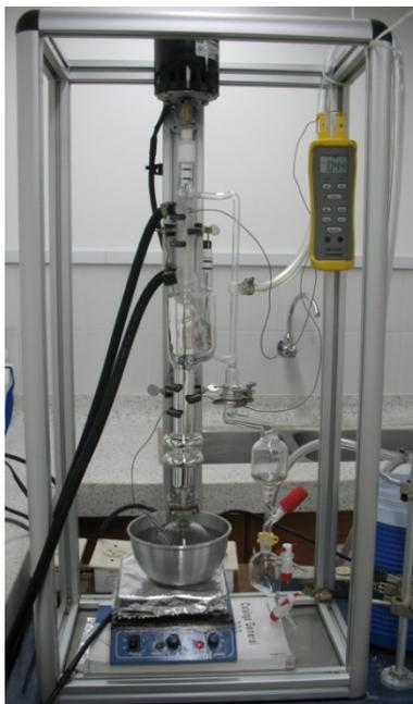
**Figura 12.** Equipo destilación fraccionada *B/R Instrument 800 – High Efficiency Micro Distillation*.
