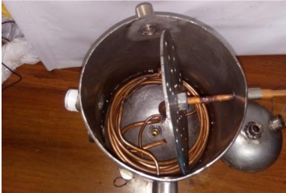
Figura 33. Serpentín de subenfriamiento y “flauta” de inter-enfriamiento.
