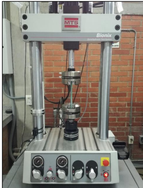
Figura 4. Máquina MTS Bionix usada para los ensayos.
