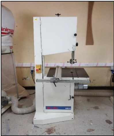
Figura 6. Sierra sin fin utilizada para corte del material.
