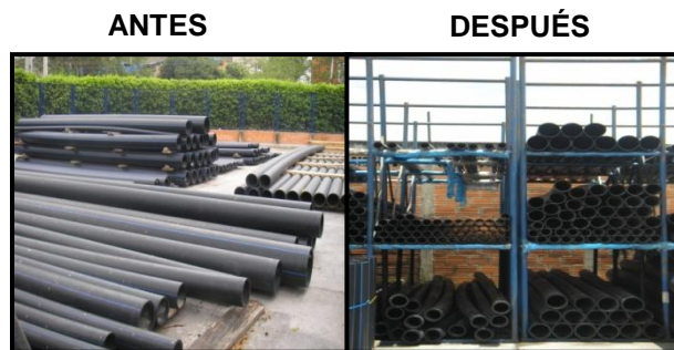
Figura 28. Almacenamiento de saldos de tubería, antes y después
