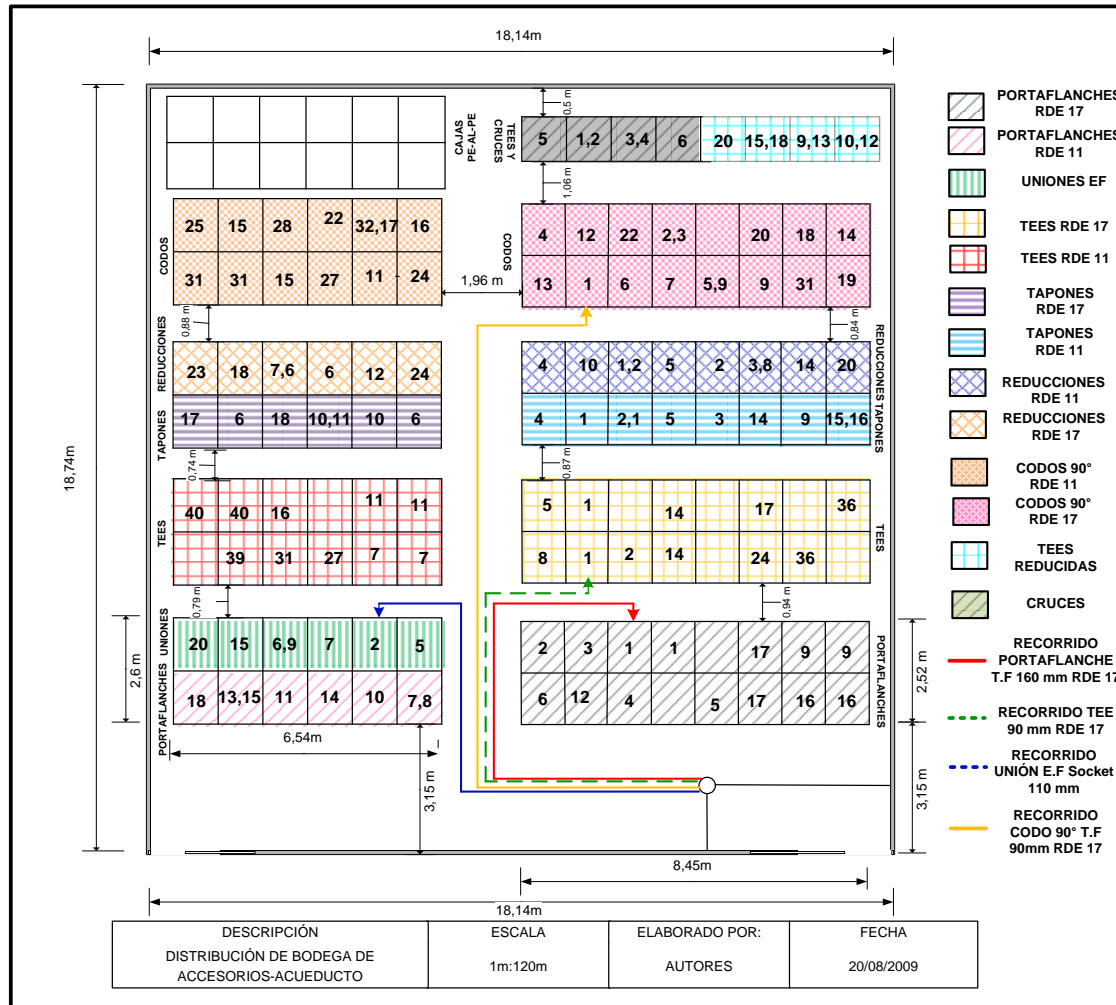
Figura 114. Diagrama de recorrido para el almacenamiento de productos en la bodega de accesorios acueducto antes de la mejora
