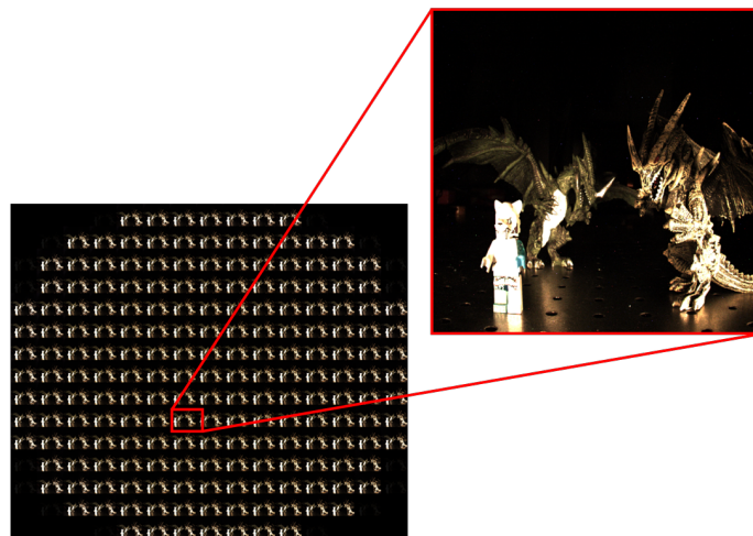
Figura 3: Resultado práctico de la parametrización. La imagen de la izquierda muestra la información angular ( \theta, \phi ) de la escena, la imagen extraída a la derecha contiene la información espacial ( x, y ) de la escena.
