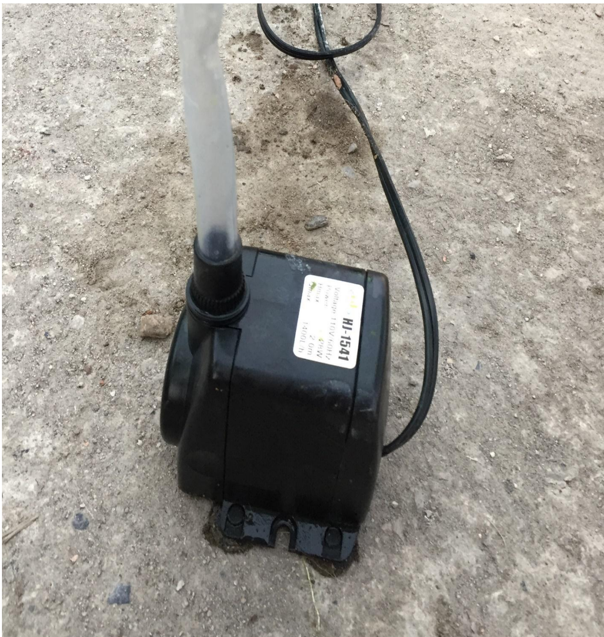
Figura 5. Motobomba con manguera de conexión.
