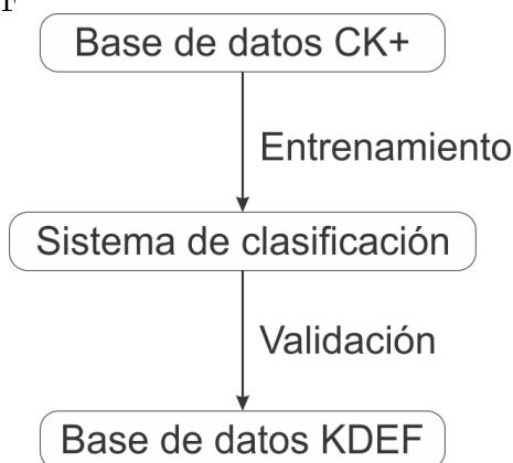
Figura 44. Entrenamiento del sistema de clasificación usado para la prueba cruzada con la base de datos KDEF
