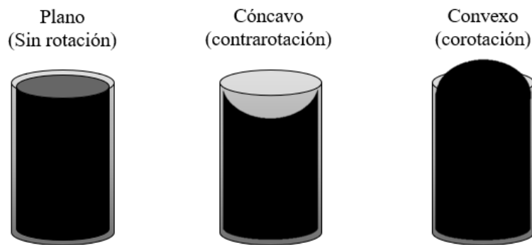
Figura 9 Sentido de rotación controlado por la forma de la superficie libre.
