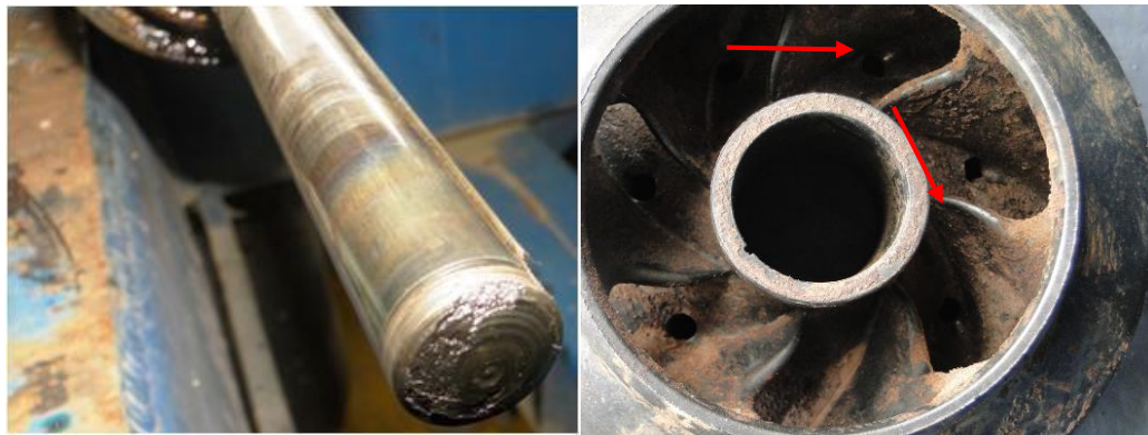
Figura 19. Eje de la bomba roto, impulsores de la bomba con desgaste severo.
