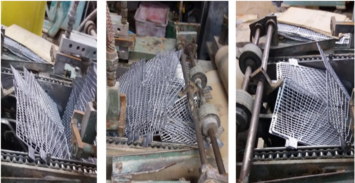
Figura 14 Atascamiento de las rejillas en la empastadora
