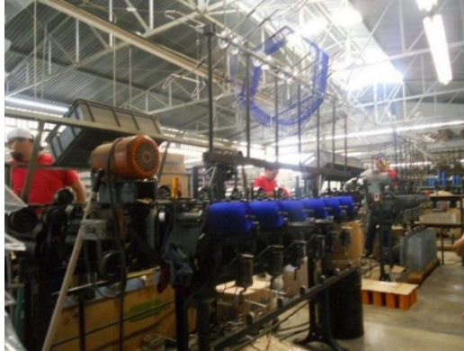
Figura 11: desmadejado y enrollado materia prima
