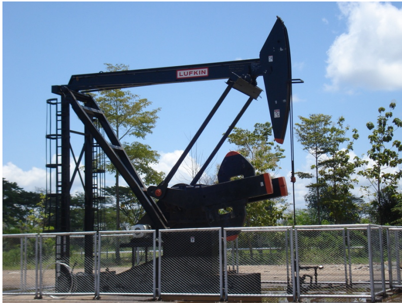
FIGURA 22: UNIDAD DE BOMBEO MARK II.
