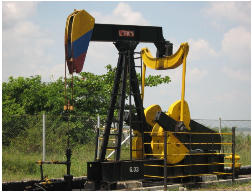
FIGURA 20: UNIDAD DE BOMBEO CONVENCIONAL FUENTE. Autores del Proyecto.
