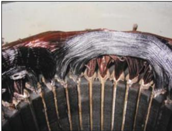
Figura 17. Muestras de quemaduras en los cabezales del devanado de un estator
