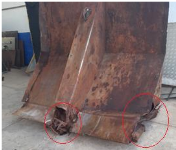
Figura 3. Cuchilla eyectora para reparación
