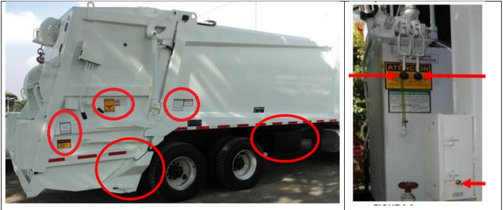
Figura 14. Señalizaciones de operación y peligros del equipo
