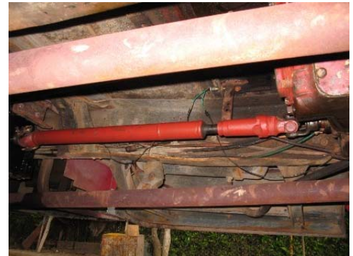
Fig. 7. Transmisión Toma potencia-Bomba
