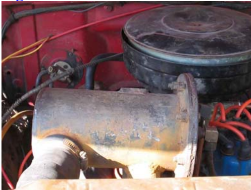
Fig. 6 Intercambiador de calor
