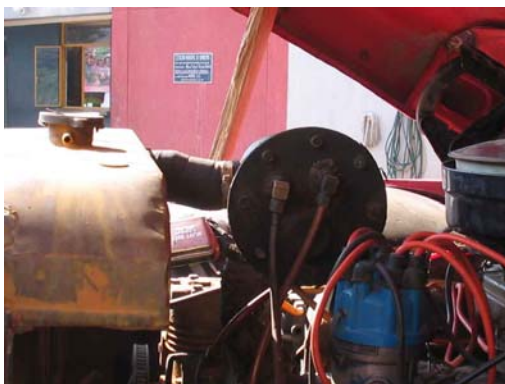
Fig. 68: Racores del intercambiador de calor
