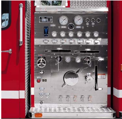
Fig. 7: Panel de control de la bomba
