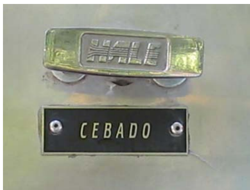
Fig. 5 Control de la bomba de cebado
