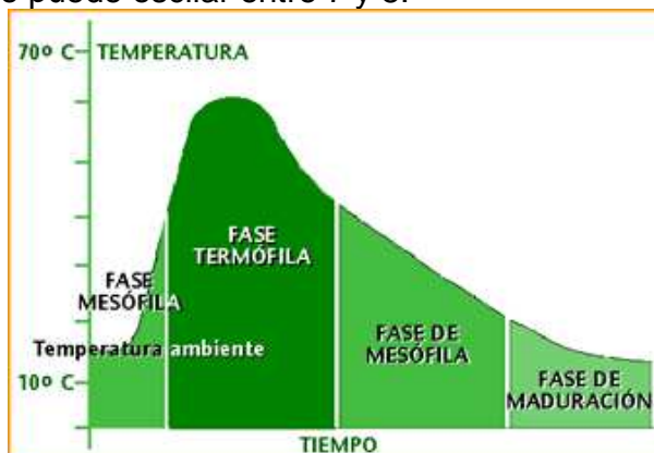
Figura 2. Temperatura y fases del proceso de compostaje
