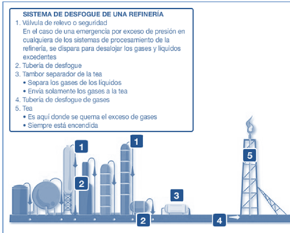
Figura 20. Sistema de desfogue de una refinera
