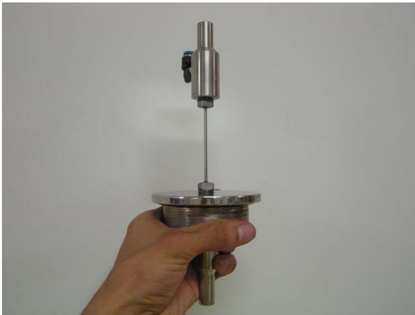
Fotografía 14. Conjunto cámaras de entrada y salida junto con la probeta.
