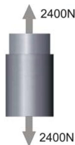
Figura 50. Fuerzas en el tubo sujetador
