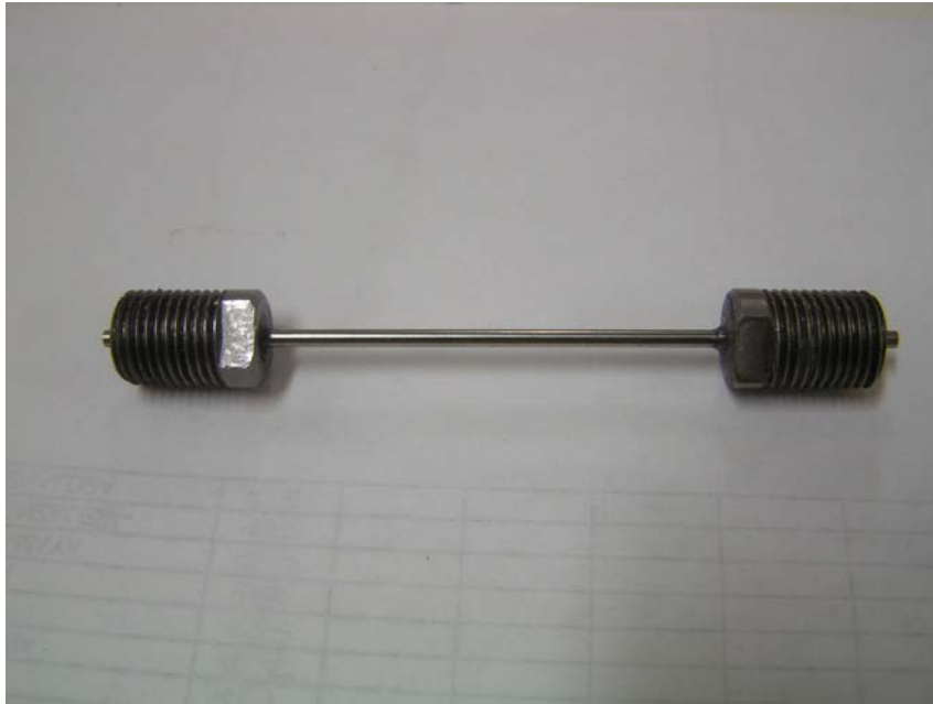
Fotografía 13. Conjunto tubos sujetadores-probeta.
