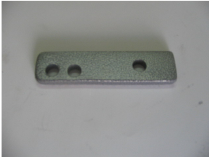
Fotografía 9. Pestaña de ajuste del sensor.
