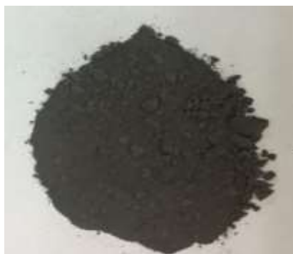
Figura 4. Componente inorgánico seco obtenido de la extracción Soxhlet del lodo tanque K-808.
