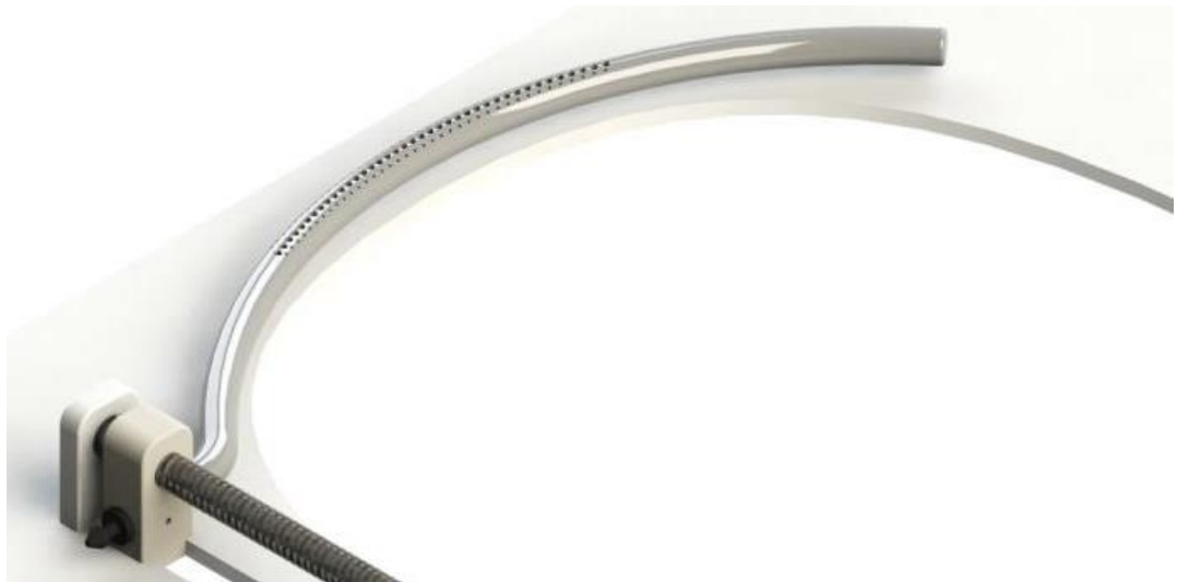
Figura 140. Diseño subsistema de aspersión por desplazamiento
