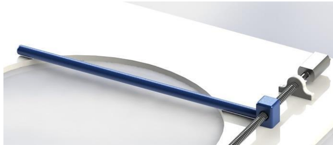
Figura 94. Elemento aspersor sistema tornillo sin fin
