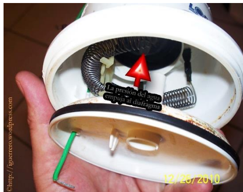
Figura 82. Ejemplo de funcionamiento resistencia de paso
