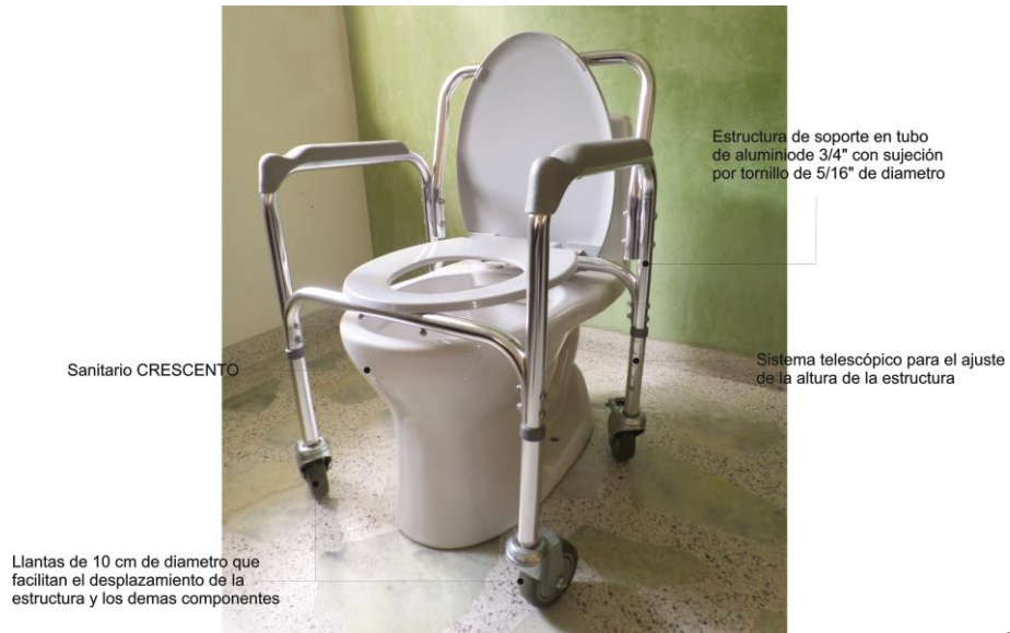
Figura 204. Características del conjunto estructura y sanitario CRESCENTO
