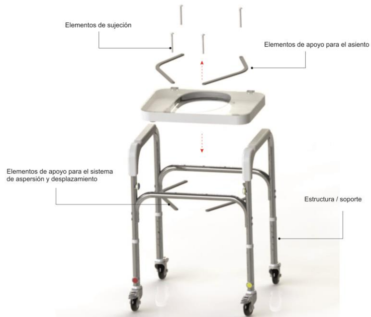
Figura 210. Montaje anticipado del componente de interacción sobre la estructura de aluminio.
