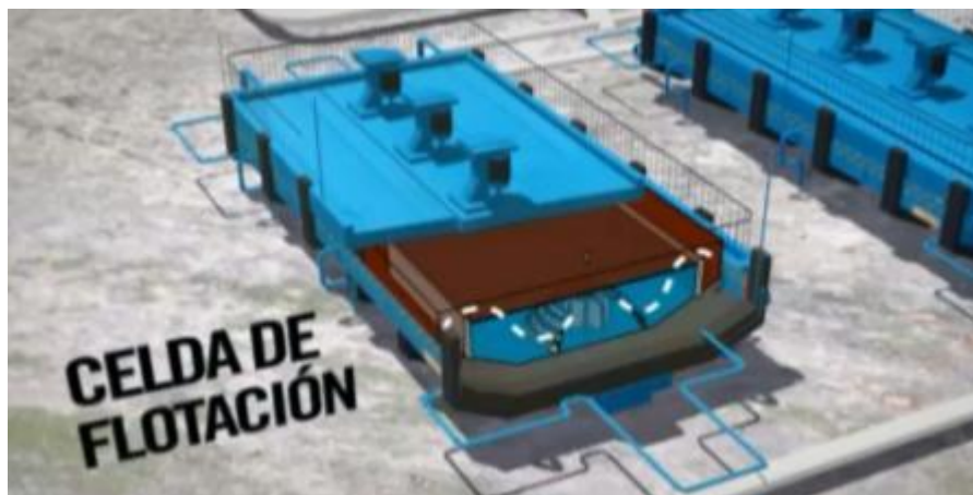
Figura 11. Celda de Flotación.
