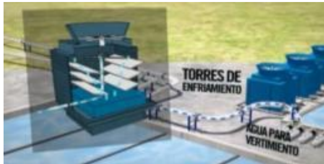
Figura 15. Torres de Enfriamiento
