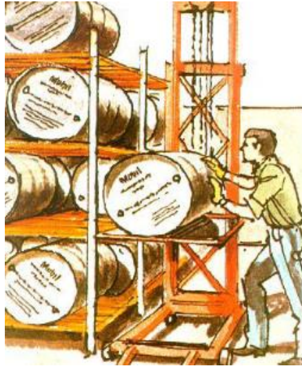
Figura 33. Almacenamiento de lubricantes en estantes.
