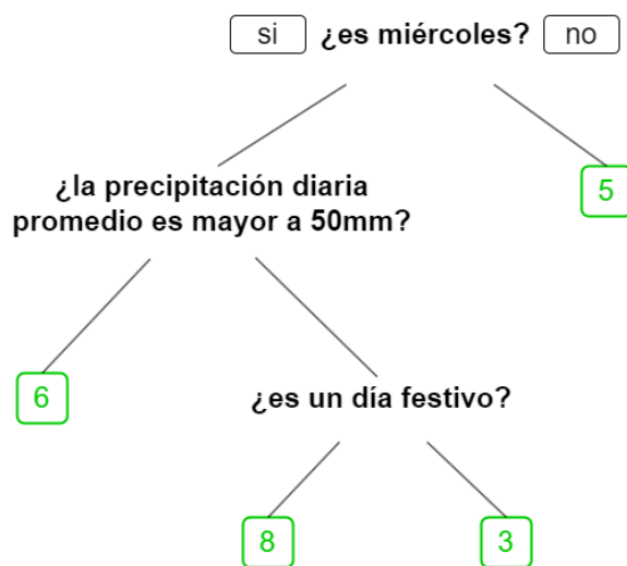
Figura 22. Un árbol de decisión que muestra la cantidad de accidentes el día siguiente en una intersección particular. las cifras debajo de las hojas muestran la cantidad.
