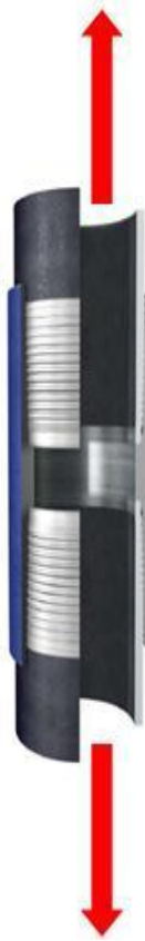
Figura 38. Cargas por tensión.
