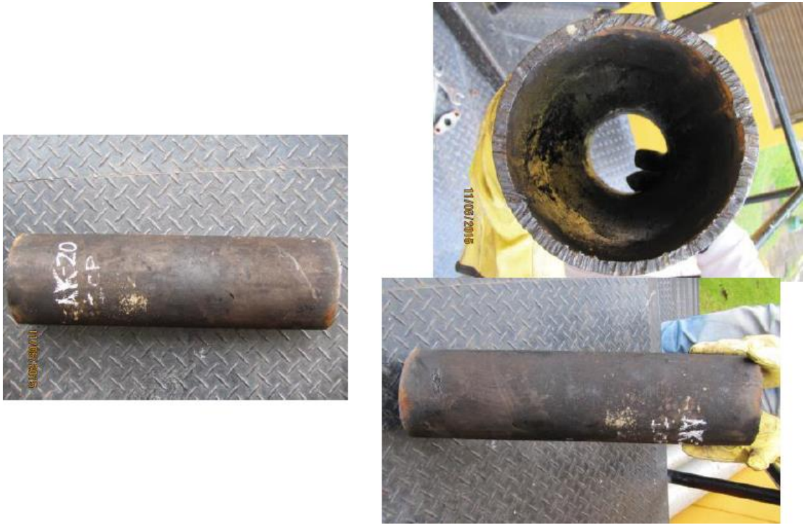
Figura 40. Muestra de tubería enviada al ICP.
