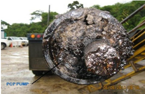
a. Bomba PCP arenada
