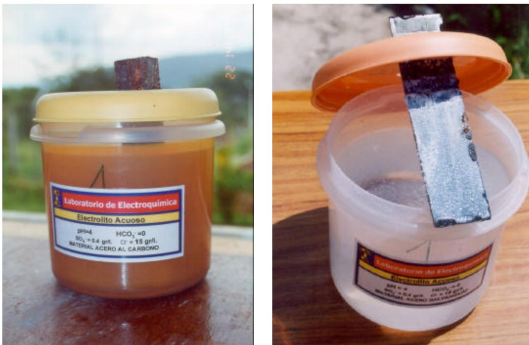
**Foto 2. Cambio en la coloración de las soluciones debido a la solubilización de los productos de corrosión.**
