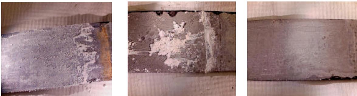
**Foto 4. Diferentes estructuras en soluciones que contienen diferentes tipos de concentración de Carbonatos además de otros contaminantes monitoreo 3. Izquierda sistema SG03, centro sistema SG07, derecha sistema SG08.**
