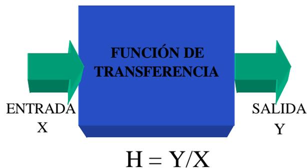
**Figura 9. Representación esquemática de la Función de Transferencia.**
