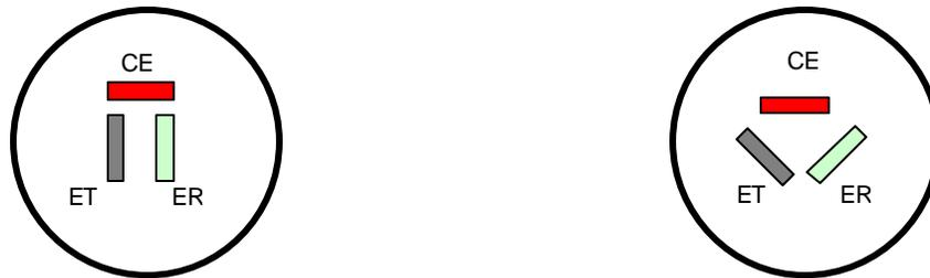
**Figura 14. Configuraciones para un sistema de tres electrodos.**
