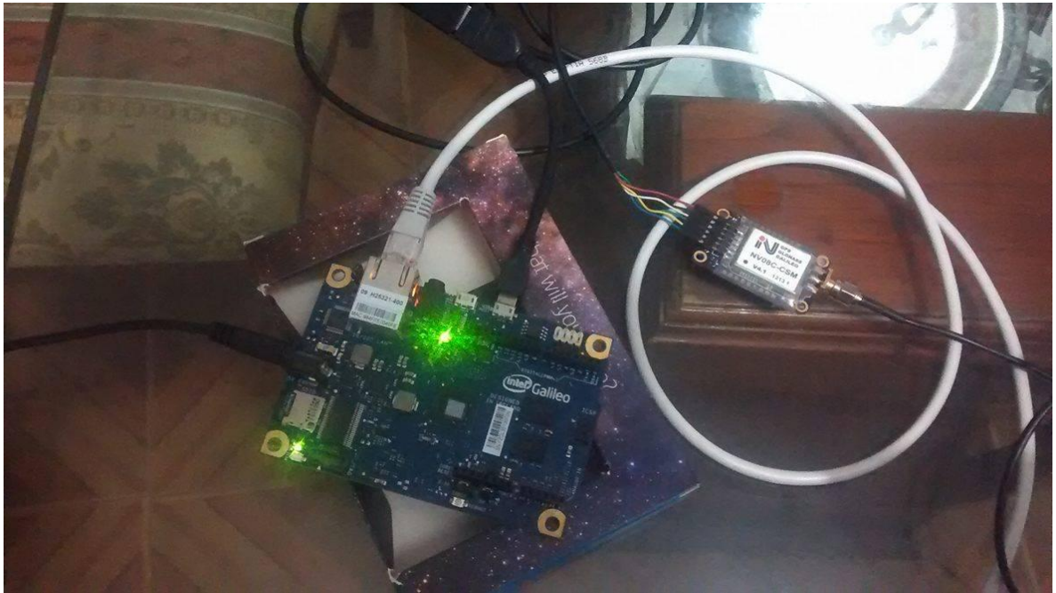
Figura 9: montaje de la placa Intel Galileo conectada al equipo host con cable ethernet y al sensor de GNSS por el USB host.
