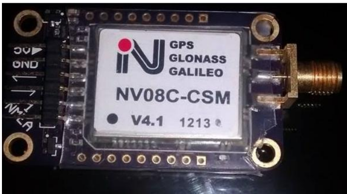
Figura 7: vista frontal del receptor de GNSS NV08C-CSM v4.1, interfaz UART A para salida en formato NMEA 0183
