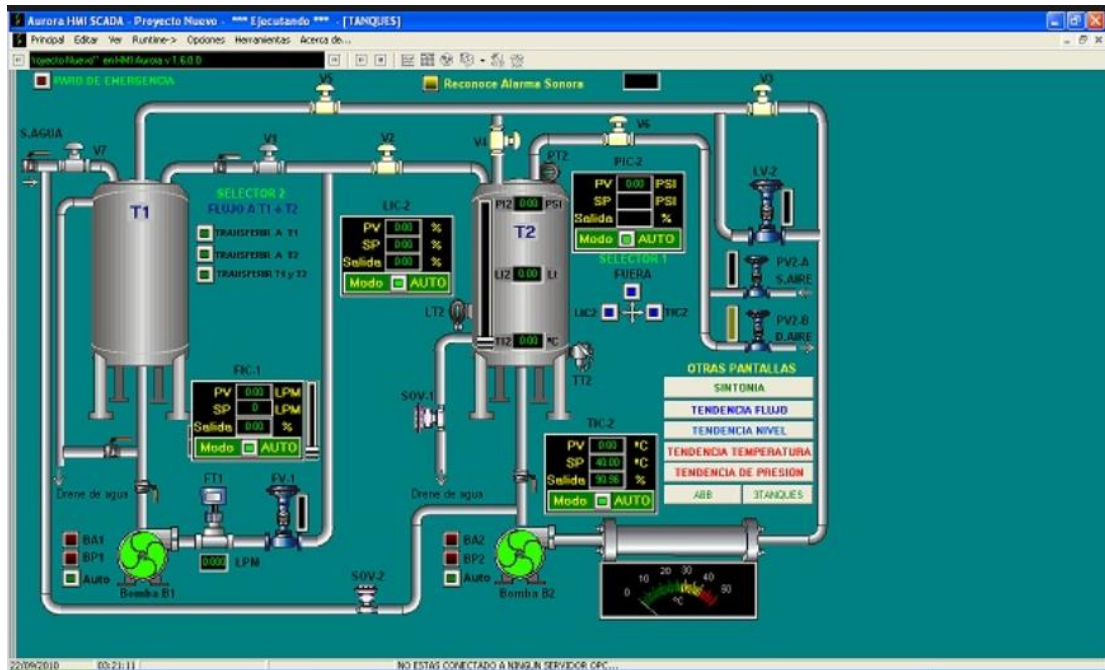
Figura 3. Ejemplo de un sistema SCADA o HMI
