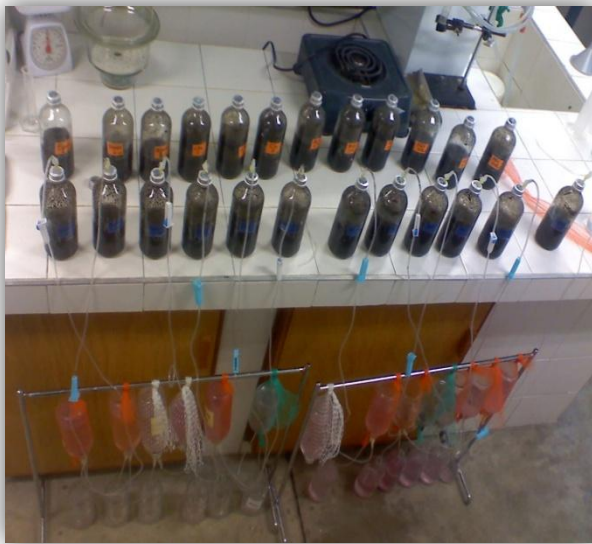
Medición de CH 4 por el método de desplazamiento alcalino
