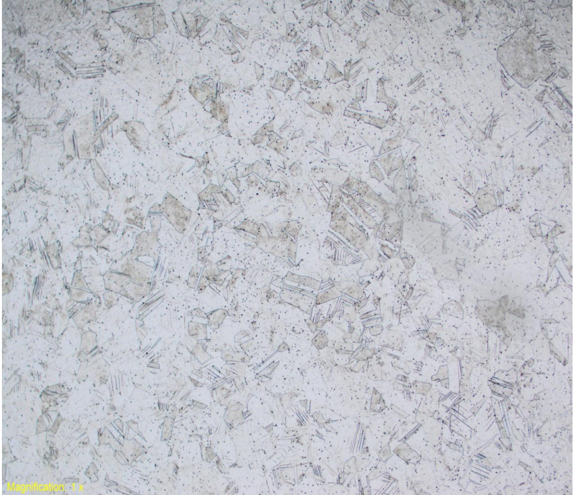
Figura 5. Micrografía del acero inoxidable 316L con a 100X.
