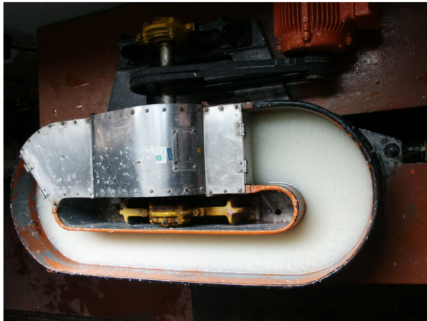
Figura 21. Refinador tipo Pila Holandesa Valley Beater
