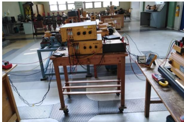
Fig. 79 Montaje en Paralelo de los dos Generadores alimentando una Carga en el Laboratorio UIS
