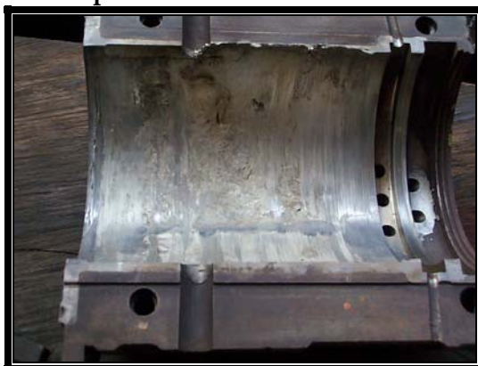
Figura 38. Desprendimiento de material en chumacera.
