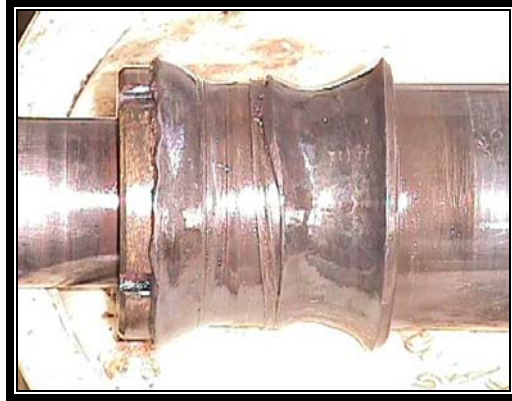
Figura 37. Desprendimiento de material en un eje.
