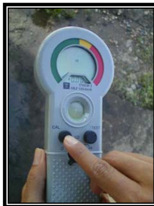
Figura 54. Calibración del analizador con una muestra de aceite nuevo.
