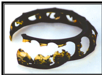
Figura 40. Falla por fricción en la canastilla.
