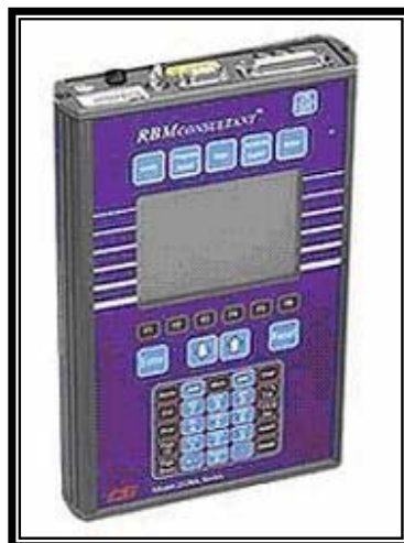
Figura 52. Analizador de vibraciones CSI 2120.
