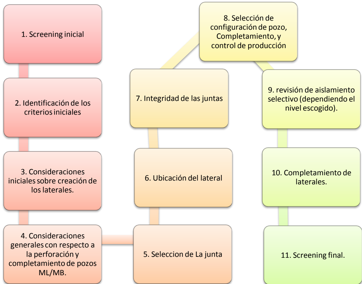
Figura 53. Orden metodológico llevado a cabo en el diseño de un pozo multilateral.
