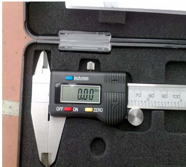
Figura 9. Pie de rey digital de 0.02mm de sensibilidad
