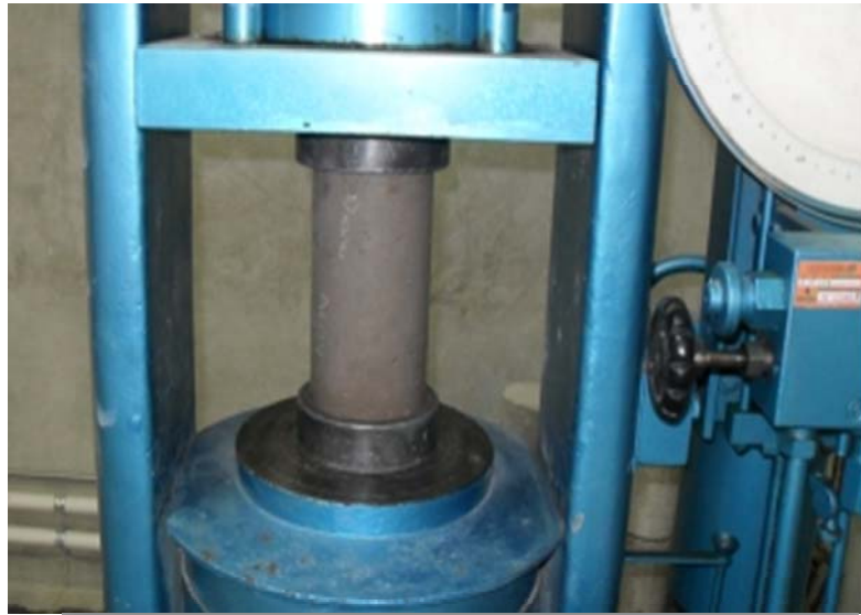
Figura 10. Disposición de la probeta para la prueba de compresión
