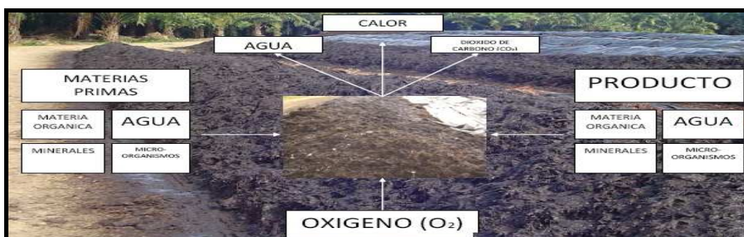
Figura No. 8. Balance de los compuestos utilizados en el compostaje.
