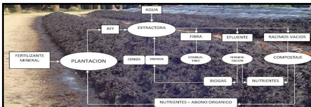
Figura No. 7 Diagrama de flujo del manejo de desechos de la planta extractora.
