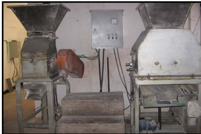
Molino laminador ubicado fuera de la planta de producción
