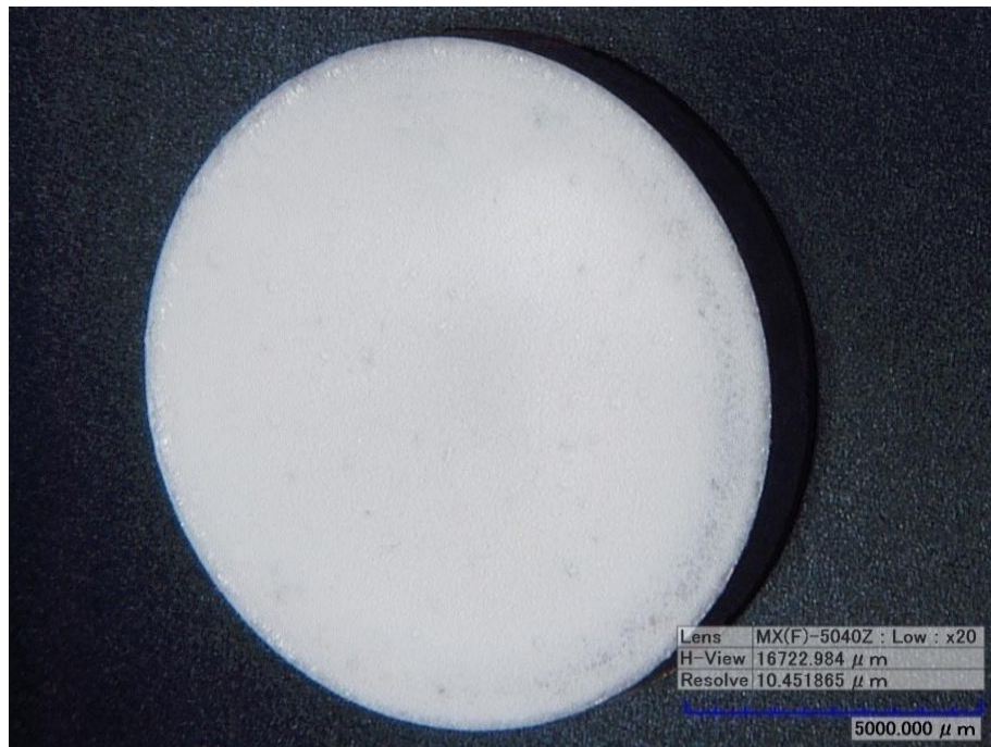
Figura 4.30. Recubrimiento R6 (140 °C y pH 10 -11), aumentos 20x
