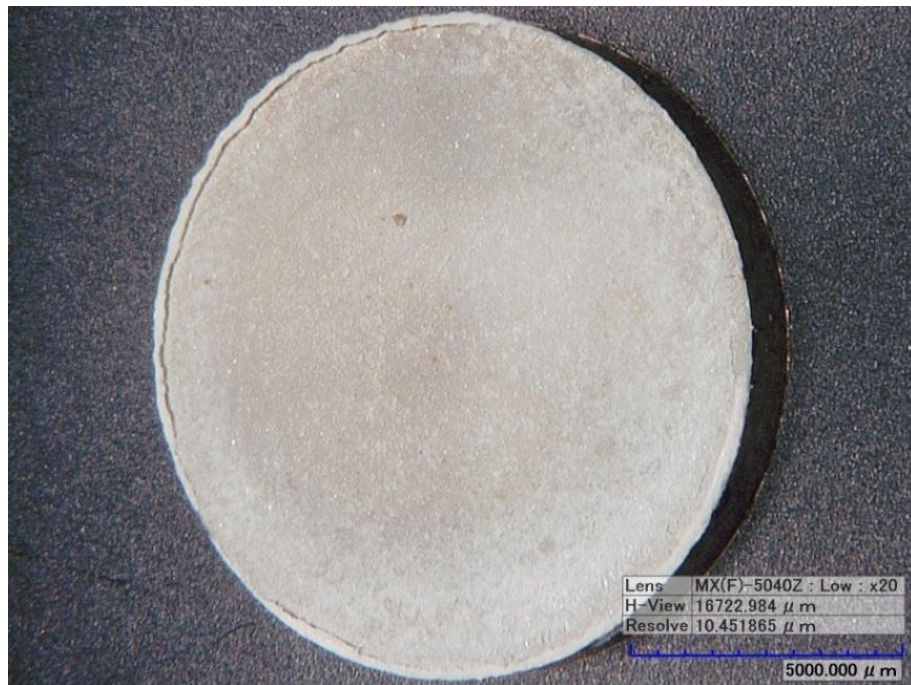
Figura 4.10. Recubrimiento R2 (60°C y pH 10-11), aumentos 20x.
