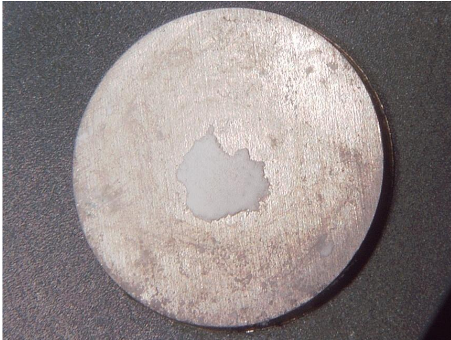
Figura 4.41. Sustrato recubierto del grupo S1, ensayado, aumentos 20x.
