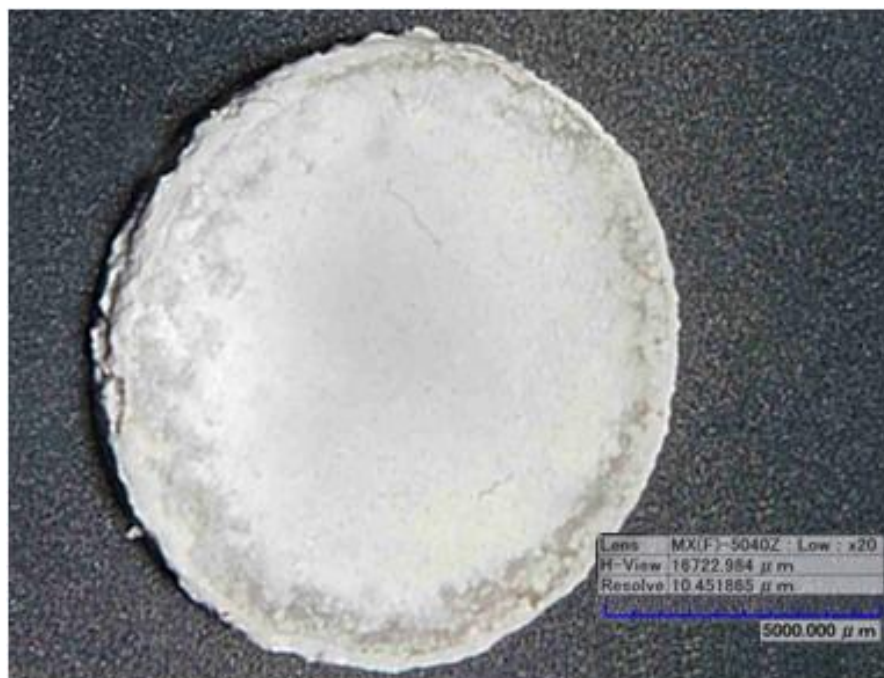
Figura 4.5. Recubrimiento R1 (100 °C y pH 4-5), aumentos 20x.
