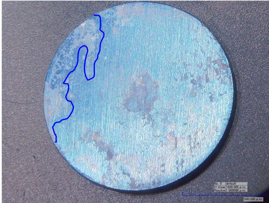
Figura 4.44. Sustrato recubierto del grupo A1, ensayado, aumentos 20x, área de rotura cohesiva resaltada en azul.
