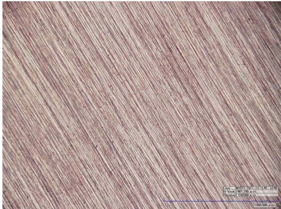
Figura 4.2. Sustrato pulido mecánicamente hasta papel abrasivo #600, aumentos 140x.
