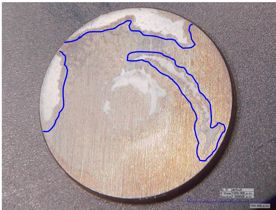
Figura 4.49. Sustrato recubierto del grupo F3, ensayado, aumentos 20x, área de rotura cohesiva resaltada en azul.
