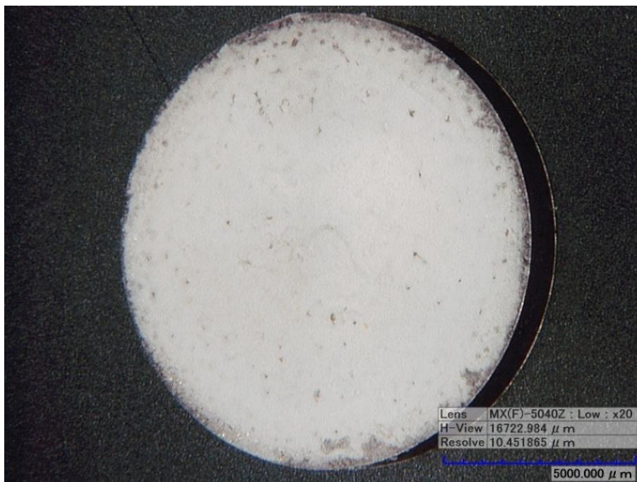
Figura 4.20. Recubrimiento R4 (100 °C y pH 10-11), aumentos 20x.
