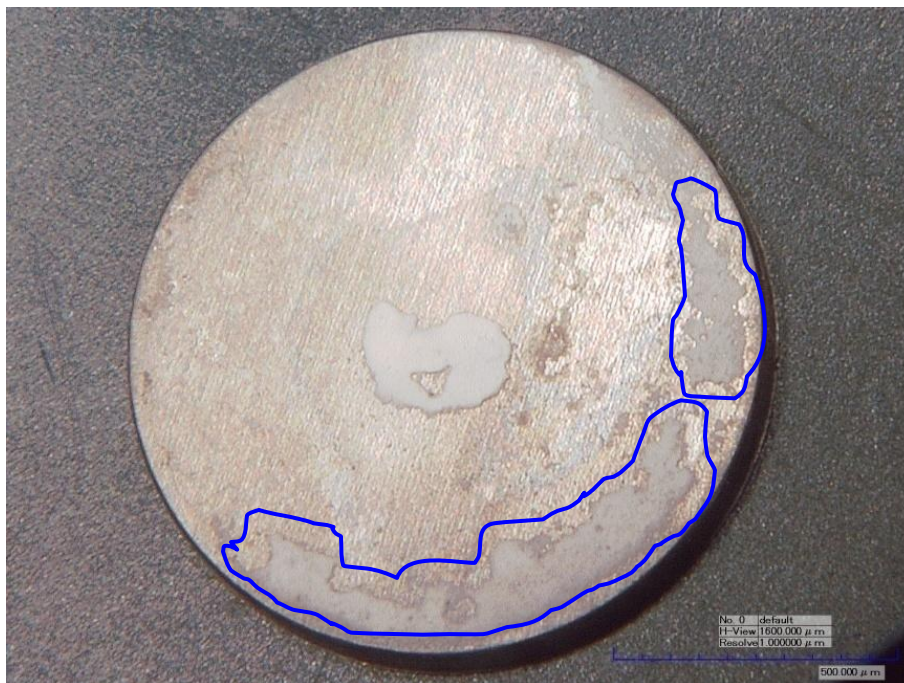
Figura 4.47. Sustrato recubierto del grupo F1, ensayado, aumentos 20x, área de rotura cohesiva resaltada en azul.
