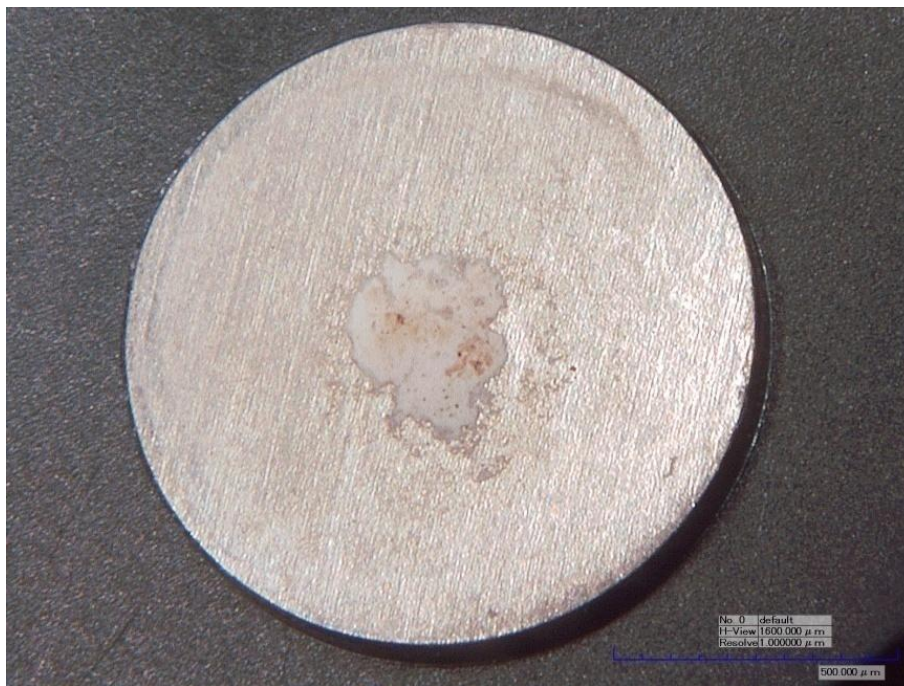
Figura 4.43. Sustrato recubierto del grupo S3, ensayado, aumentos 20x.
