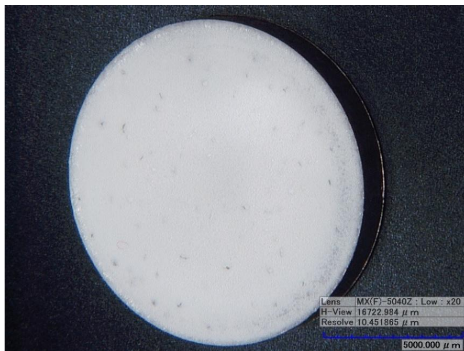
Figura 4.25. Recubrimiento R5 (120 °C y pH 10-11), aumentos 20x.
