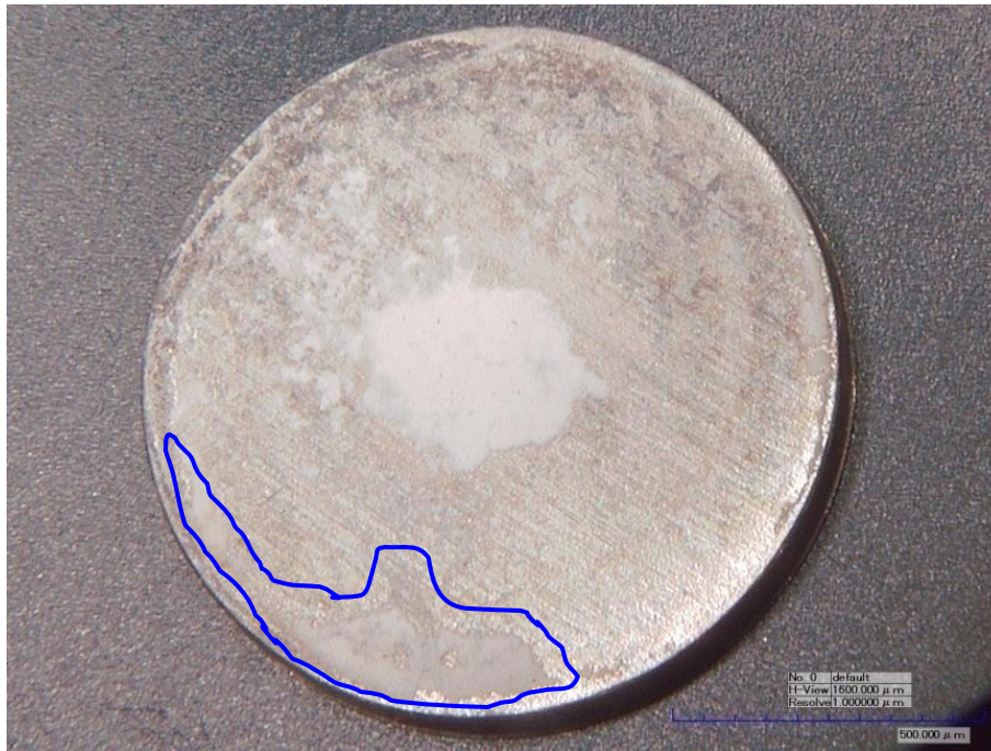
Figura 4.42. Sustrato recubierto del grupo S2, ensayado, aumentos 20x, porción de rotura cohesiva resaltada en azul.
