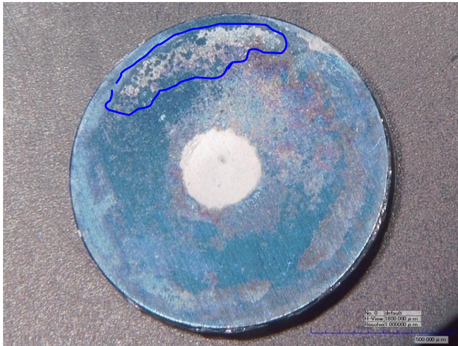
Figura 4.45. Sustrato recubierto del grupo A2, ensayado, aumentos 20x, área de rotura cohesiva resaltada en azul.
