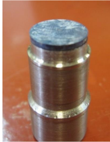
Figura 3.8. Sustrato recubierto adherido al pin de ensayo.
