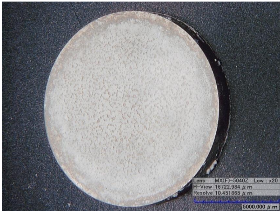
Figura 4.15. Recubrimiento R3 (80 °C y pH 10-11), aumentos 20x.
