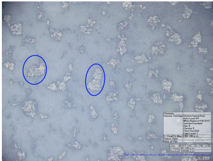
Figura 4.16. Recubrimiento R3 (80 °C y pH 10-11), aumentos 140 x, zonas sin recubrimiento resaltadas en azul.
