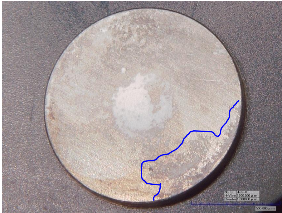
Figura 4.48. Sustrato recubierto del grupo F2, ensayado, aumentos 20x, área de rotura cohesiva resaltada en azul.
