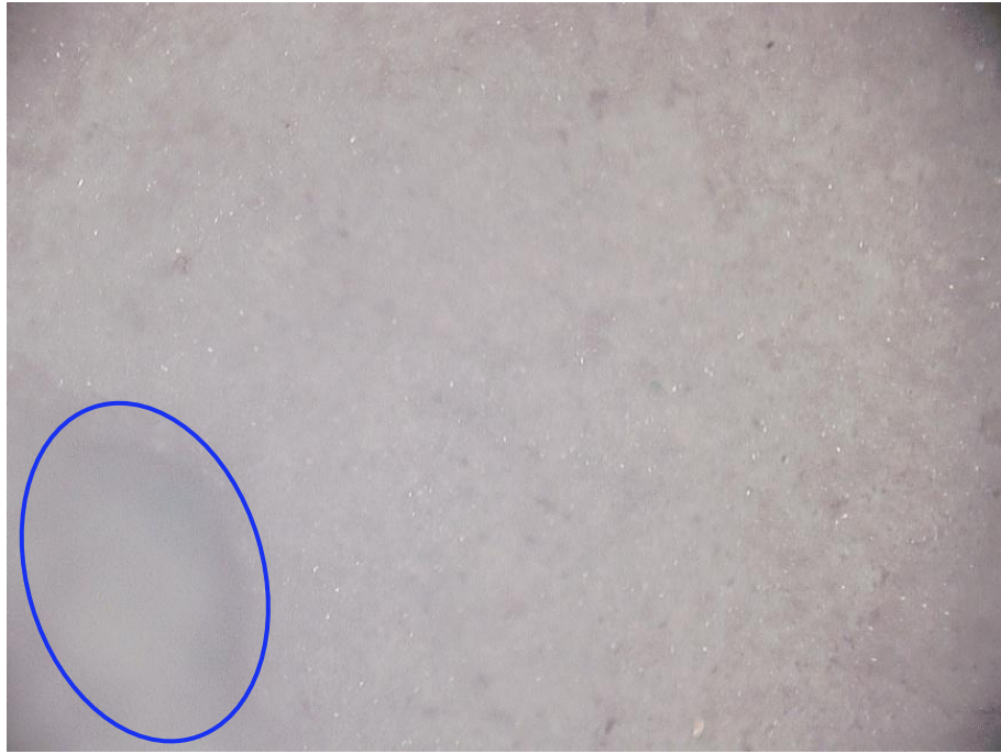
Figura 4.6. Recubrimiento R1 (100 °C y pH 4-5), aumentos 140x, zona de acumulación de recubrimiento resaltada en azul.
