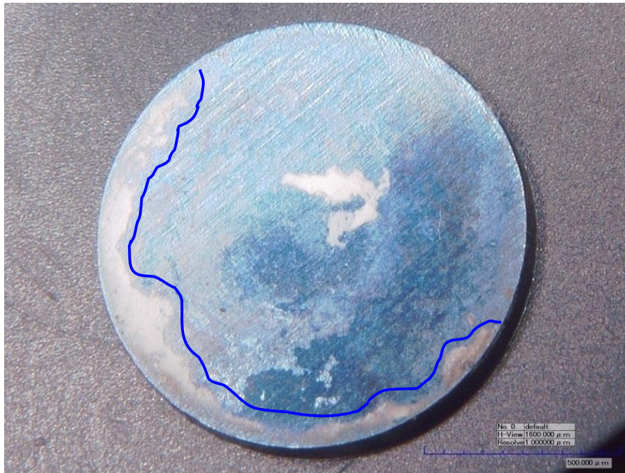
Figura 4.46. Sustrato recubierto del grupo A3, ensayado, aumentos 20, área de rotura cohesiva resalta en azul.
