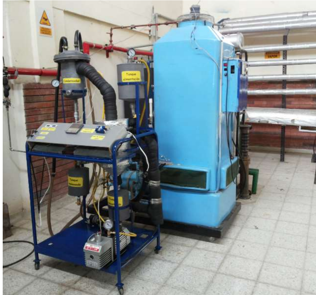
Figura 53. Foto del sistema de evaporación al vacío para la depuración de aguas residuales construido.
