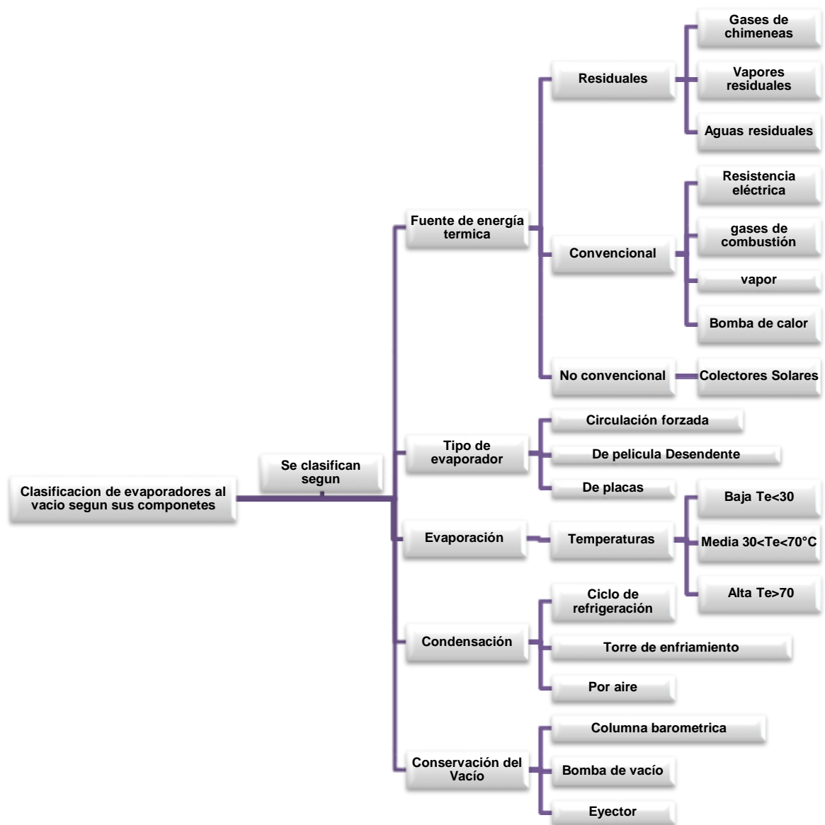
Figura 7. Clasificación de los evaporadores al vacío según sus componentes
