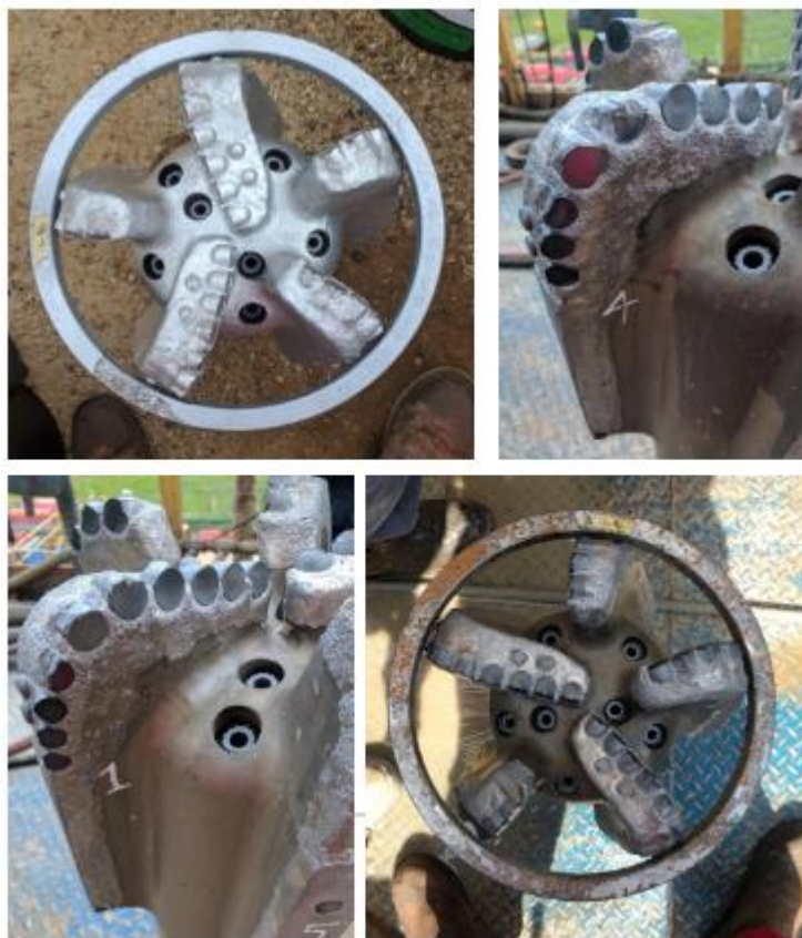
Figura 39. Estado de salida de la broca con cortador convencional.
