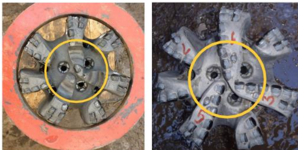
Figura 28. Cara de la broca con cortador convencional vs cara de la broca Stabilis.
