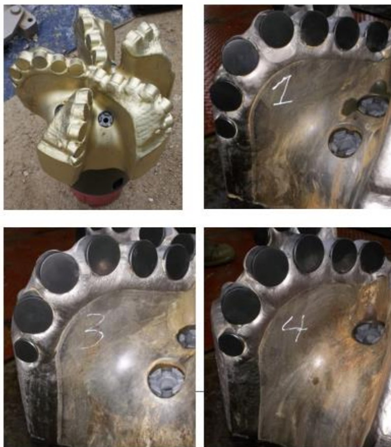
Figura 40. Estado de salida de la broca configurada con cortadores Stabilis Dual chamfer.
