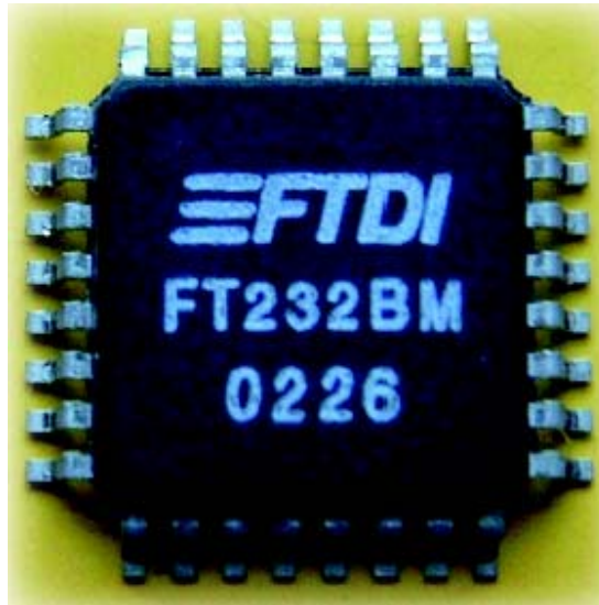
Figura 12. Encapsulado controlador USB 2.0 FT232BM
