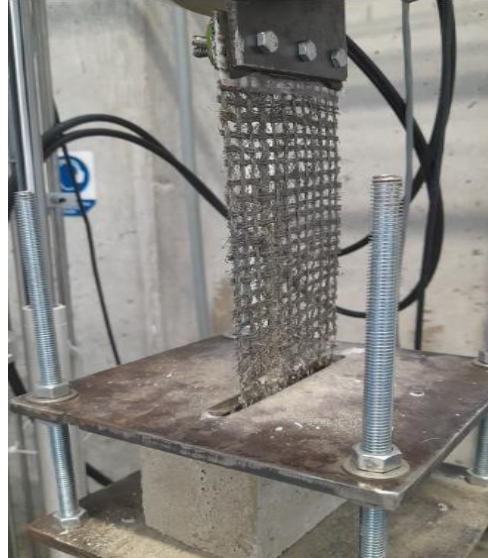
Figura 3. Montaje de ensayos de pull-out
