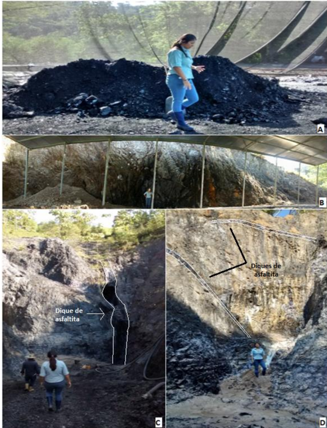
Figura 16. Instalaciones de la mina el Edén. A. Material extraído directo para empacar. B. Zona de carga de la asfaltita. C. Excavación donde se realiza la extracción del material asfáltico, se observa una veta de gran tamaño. D. Diques de material asfáltico.
