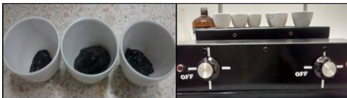
Figura 35. Procedimiento punto de ablandamiento.
