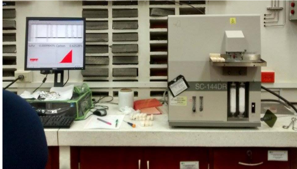
Figura 29. Equipo Leco SC-144R y software SC144R utilizado en la determinación de contenido de TOC y azufre.
