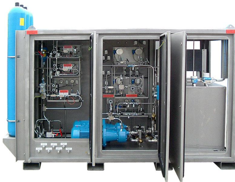
Figura 1. Panel de control de cabeza de pozo 10K
