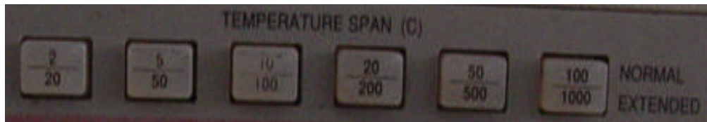
Ilustración 14. Control de SPAN
