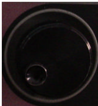
Ilustración 15. Perilla para cuadrar temperatura.
