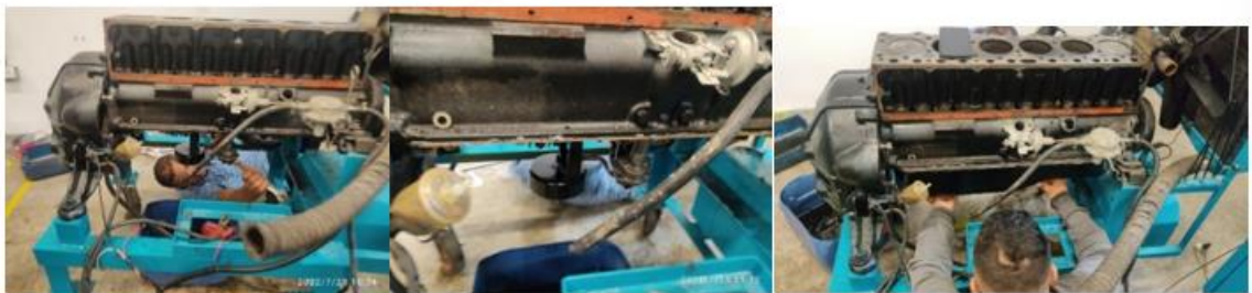
Instalación bomba de aceite y cárter
