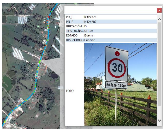
Figura 15. Consulta Señal SR-30 del tramo K12+270
