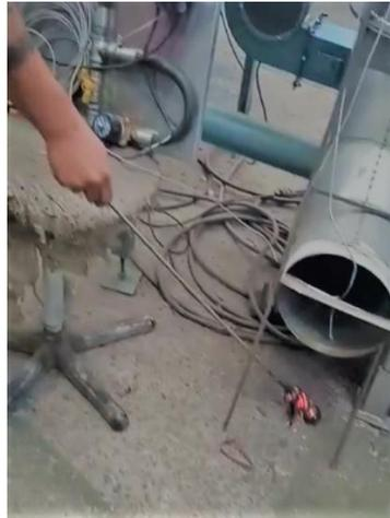
Por medio de un sistema de medición de temperatura proporcionado por la empresa, el cual consta de una termocupla, conectada a un tablero digital para obtener el control de la temperatura de salida del calefactor. Para la verificación y calibración de la termocupla se procede a hacer mediciones a recipientes con agua con hielo y un recipiente con una resistencia térmica y agua, para efectuar el control de la temperatura de salida del generador de calor.
