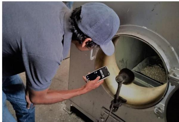
**Figura 72.** Pruebas de la velocidad de salida de aire, ventilador de combustión
