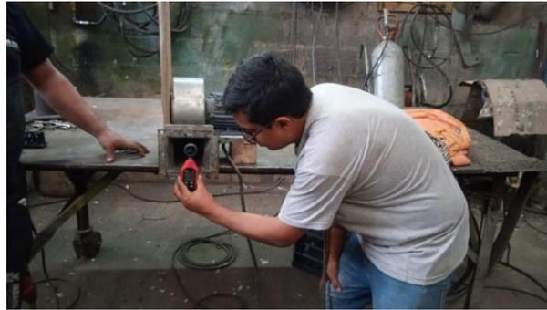
Seguidamente se cierra la puerta del calefactor y se inicia la salida de aire, con la termocupla lista se procede a realizar el seguimiento a la temperatura de salida, una vez transcurrida la prueba se verifica la cantidad de cenizas generadas por el trabajo realizado por el generador de calor.
